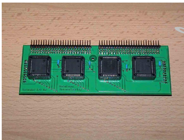
Afbeelding van een uitbreiding I/O voor 96 terugmeldingen (PCI- Kaart)
