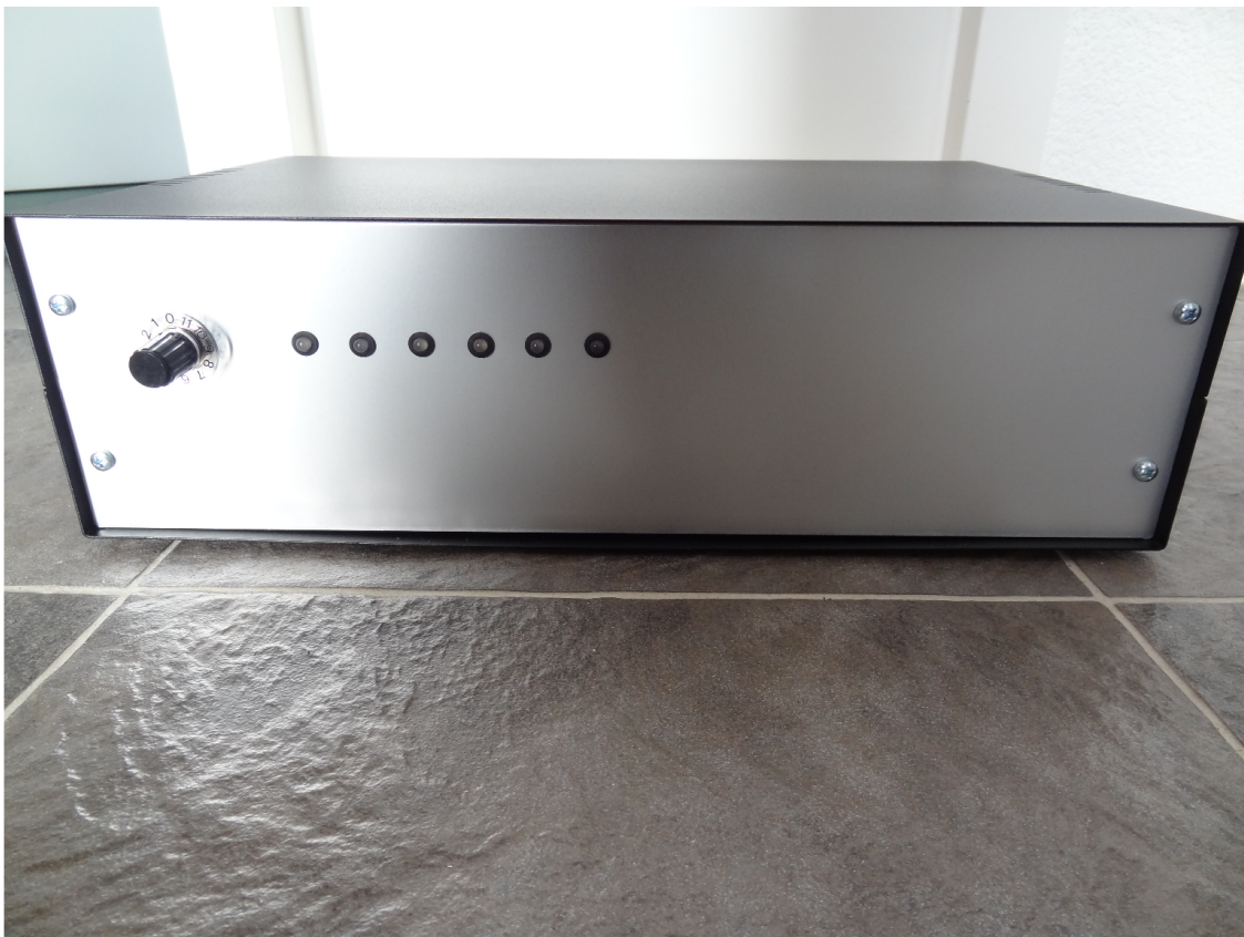
Booster 10 ( Power-10 ) Ampère met ingebouwde transformator (300 VA)
